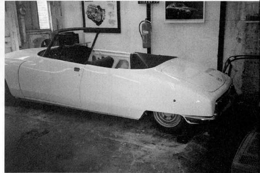
Een Oord Cabriolet in het afwerkstadium; let op de aangepaste achterbumper
