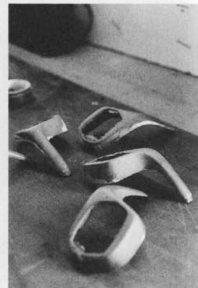
Reflectorhouders van gegoten brons, die later verchromd zullen worden
