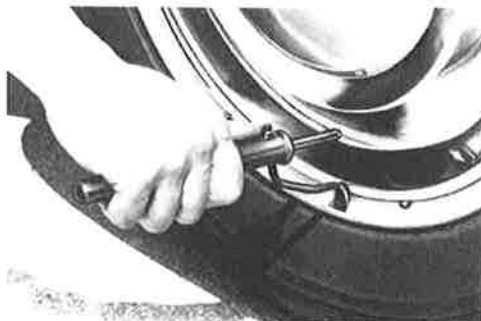
Afb. 36 — Montage van de wioldop (groot model)
