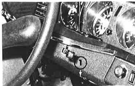
Afb. 12 — Starten met de slinger (uitvoering hydraulique) 1 — Handfrictiebediening
