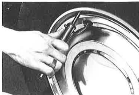
Afb. 33 — Verwijderen van een wioldop (groot model)
