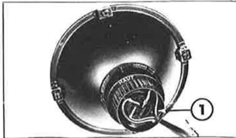
Afb. 38 -- Groot-dimlicht (grote Ø) Cibié gloeilamp 1 -- startlicht (zie blz. 33)
