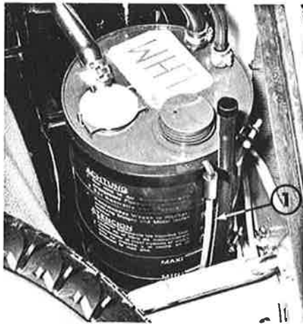
Afb. 26 — Reservoir hydraulisch systeem 1 — Peilglas
