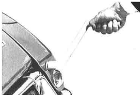
Afb. 32 — Verwijderen van een achterspatscherm
