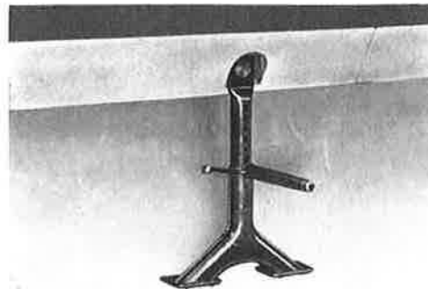
Afb. 34 — Aanbrengen van de wagensteun
