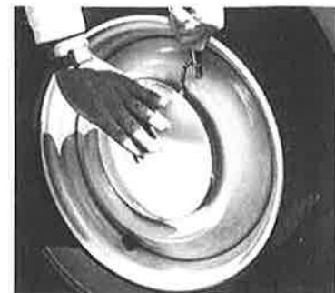
Afb. 33 bis. — Verwijderen van een wioldop (klein model)
