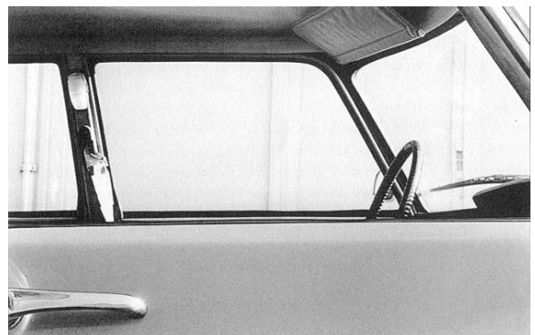
foto 3, de bovenkant van de portieren links en rechts, moeten exact parallel lopen
